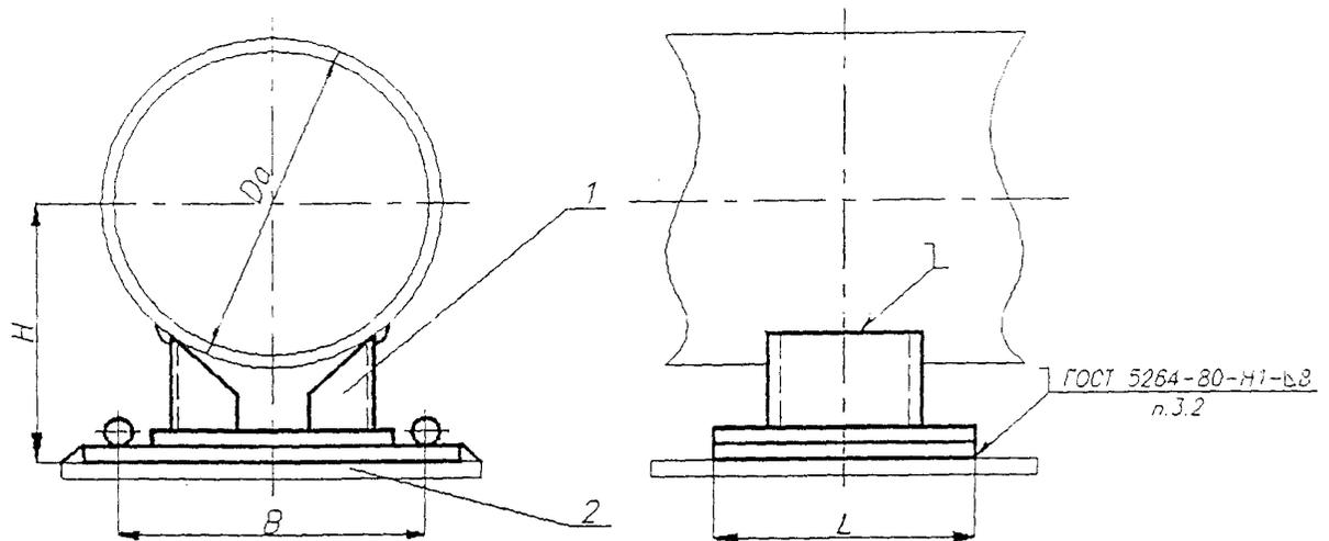
1 – опора приварная; 2 – плита направляющая
